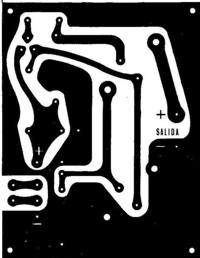
Fig. 6 - Circuito impreso a tamaño natural del alimentador de 3-4 amperios.
